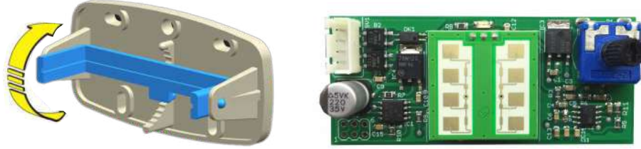
Şekil 2 : Algılama Açısının Ayarlanması Figure 2: Calibration Angle Adjustment
